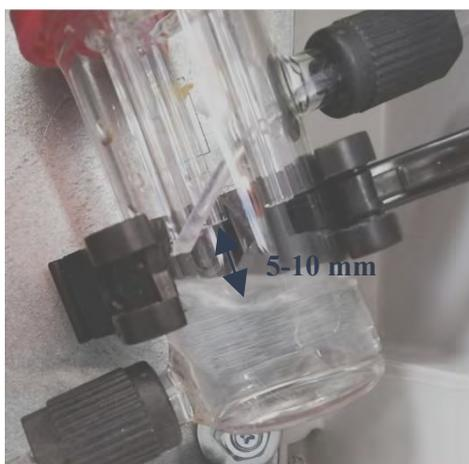
**Figure 26: Optimal Impinger cap position**
